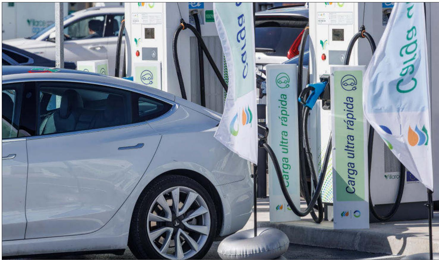
La instalación de carga ultrarrápida tiene un tiempo de recarga del coche eléctrico de 15 minutos. SANTI OTERO
